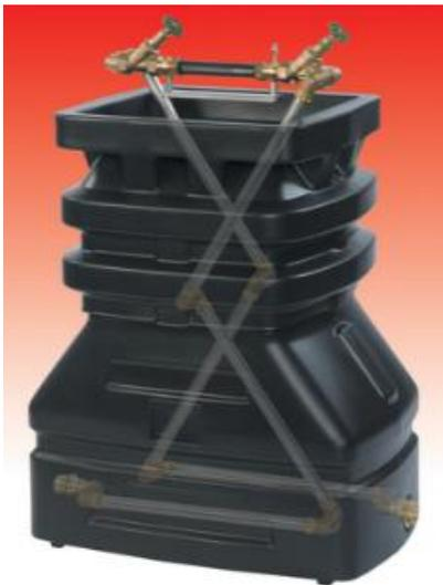
Ist für die Einbringung des Wasserhausanschlusses keine der zuvor beschriebenen Hausanschlusseinrichtungen nach DIN 18012 möglich, bietet sich für Anschlüsse bis  $Q_n = 10\text{m}^3/\text{h}$  DN50 ein Wasserzählerschacht an.
